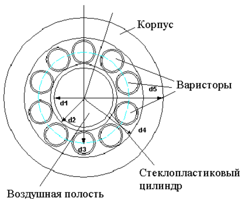
Рис. 6. Сечение аппарата ограничения перенапряжений многоколоночной конструкции
