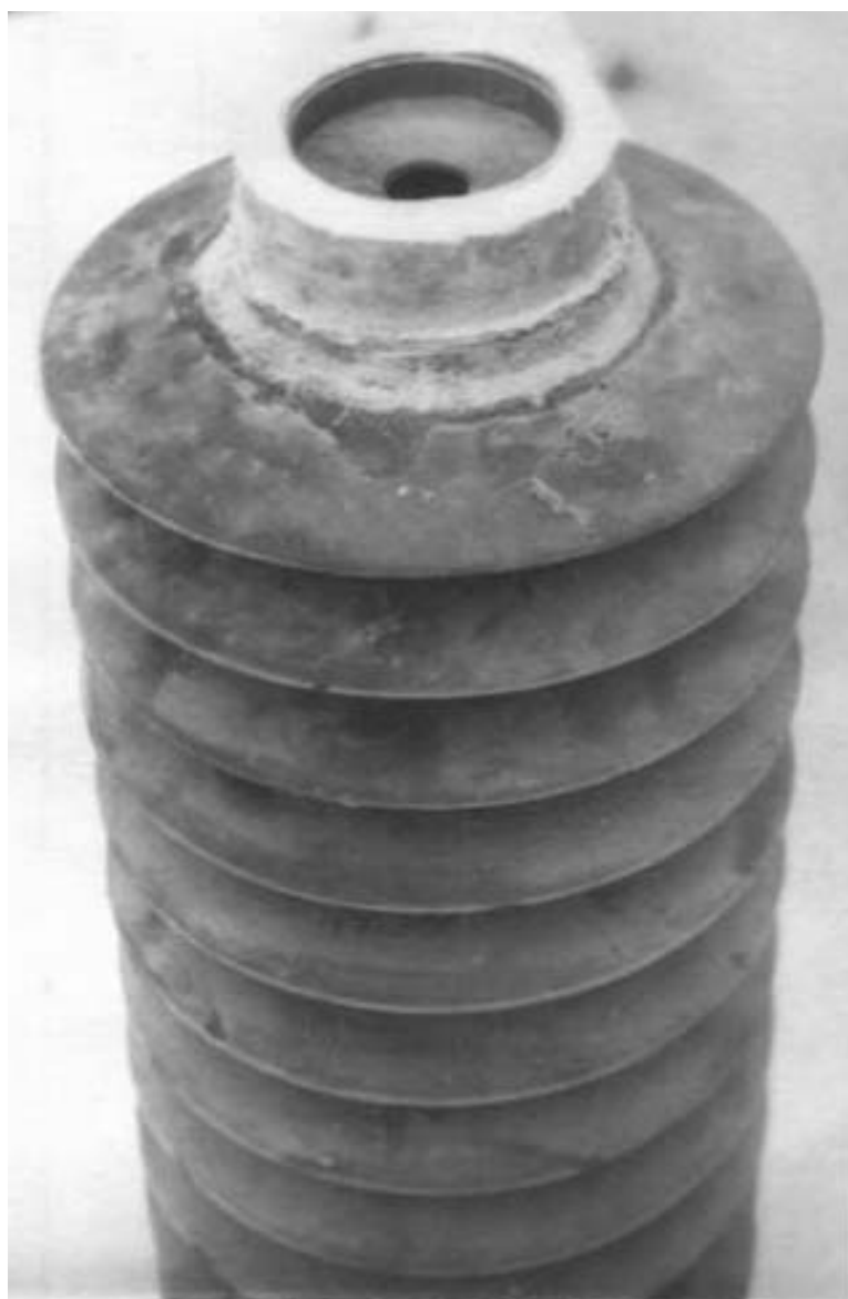
Рис. 6. Внешний вид наружного защитного покрытия полового полимерного изолятора с северной стороны, расположенной рядом с фарфоровым изолятором
