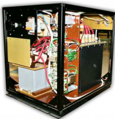
Рис.16 Вид на генератор высоковольтных импульсов ГВИ-2000
