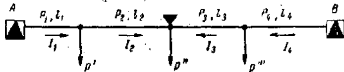
Рис. 35. Линия с двусторонним питанием При одинаковом сечении всех участков линии
