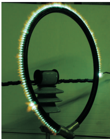
Рис. 6. Разрядник мульти-камерный на 20 кВ, для защиты от прямого удара молнии (РМК-20-П).
