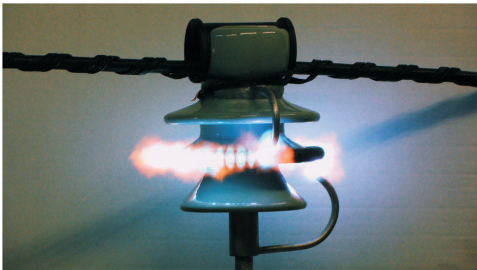
Рис. 14. Изолятор-разрядник мульти-камерный на основе изолятора SDI 37.
