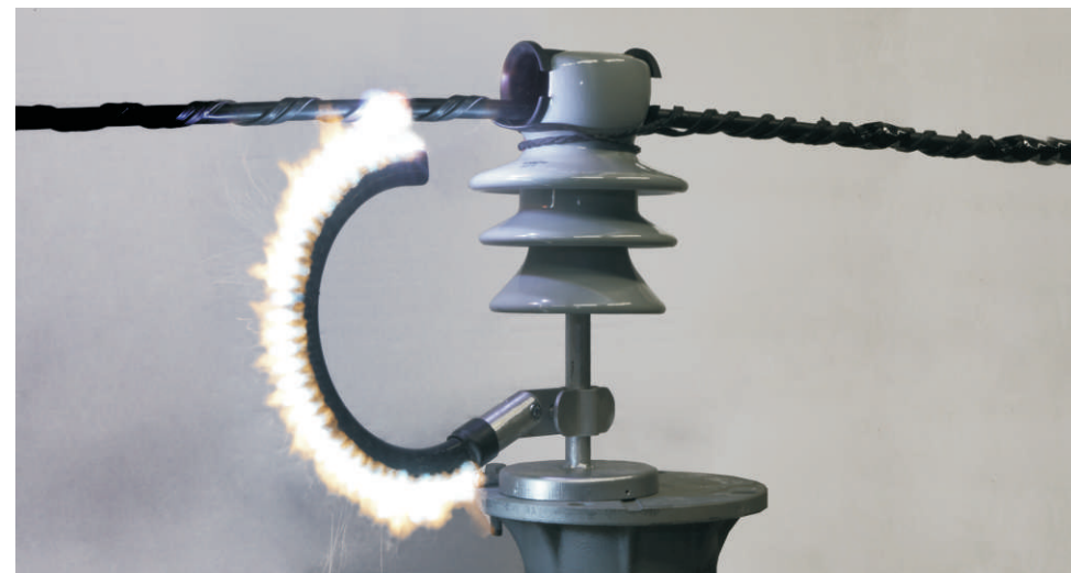
Рис. 5. Разрядник мульти-камерный для защиты ВЛ 10 кВ от прямого удара молнии и ВЛ 20 кВ от индуктированных перенапряжений (РМК-10-П, 20-И).
